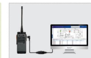
Conecte el radio al computador en donde está instalado el software Patrol
